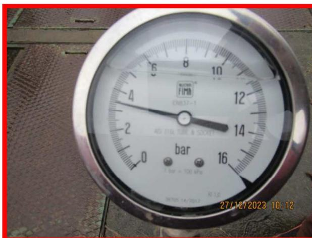
Durante le prove state effettuate quattro letture, che hanno permesso di definire con buona approssimazione la curva caratteristica dell'acquedotto, utile per poter valutare le potenzialità e/o i limiti del sistema di alimentazione, con i seguenti risultati:
