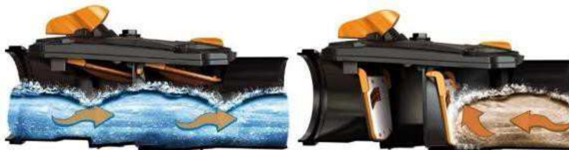
Figura 65 - Funzionamento del sistema antiriflusso
