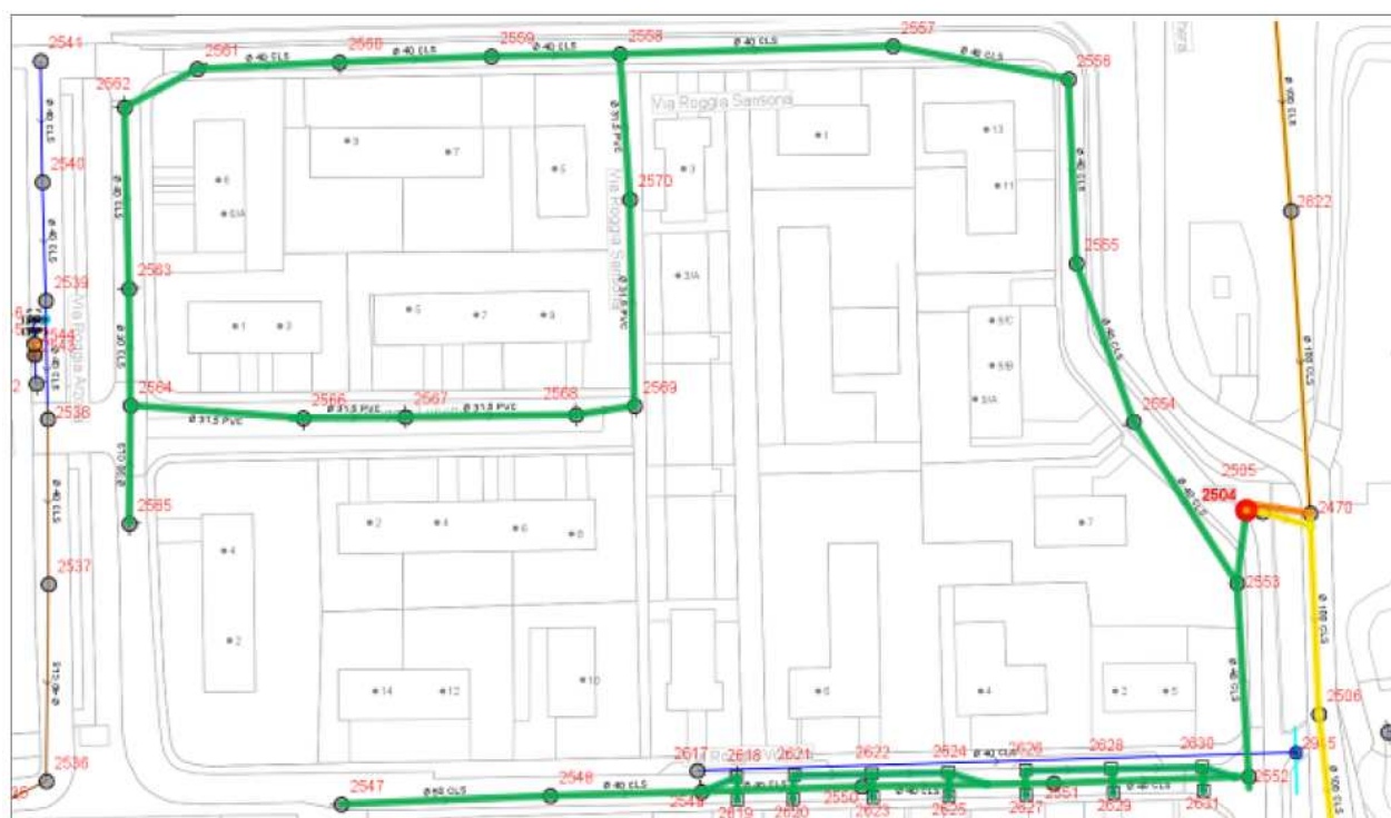
Figura 34 - Estratto rete CAP con evidenziata l'analisi topologica relativa ai tratti di rete (in verde) che insistono sulla stazione di sollevamento (punto rosso) ed il tratto a valle della stazione (in giallo)
