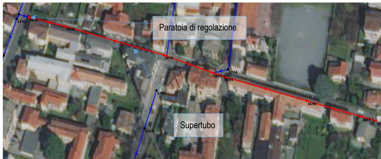
Figura 2 Schematizzazione laminazione in linea (supertubo) in Infoworks ICM
