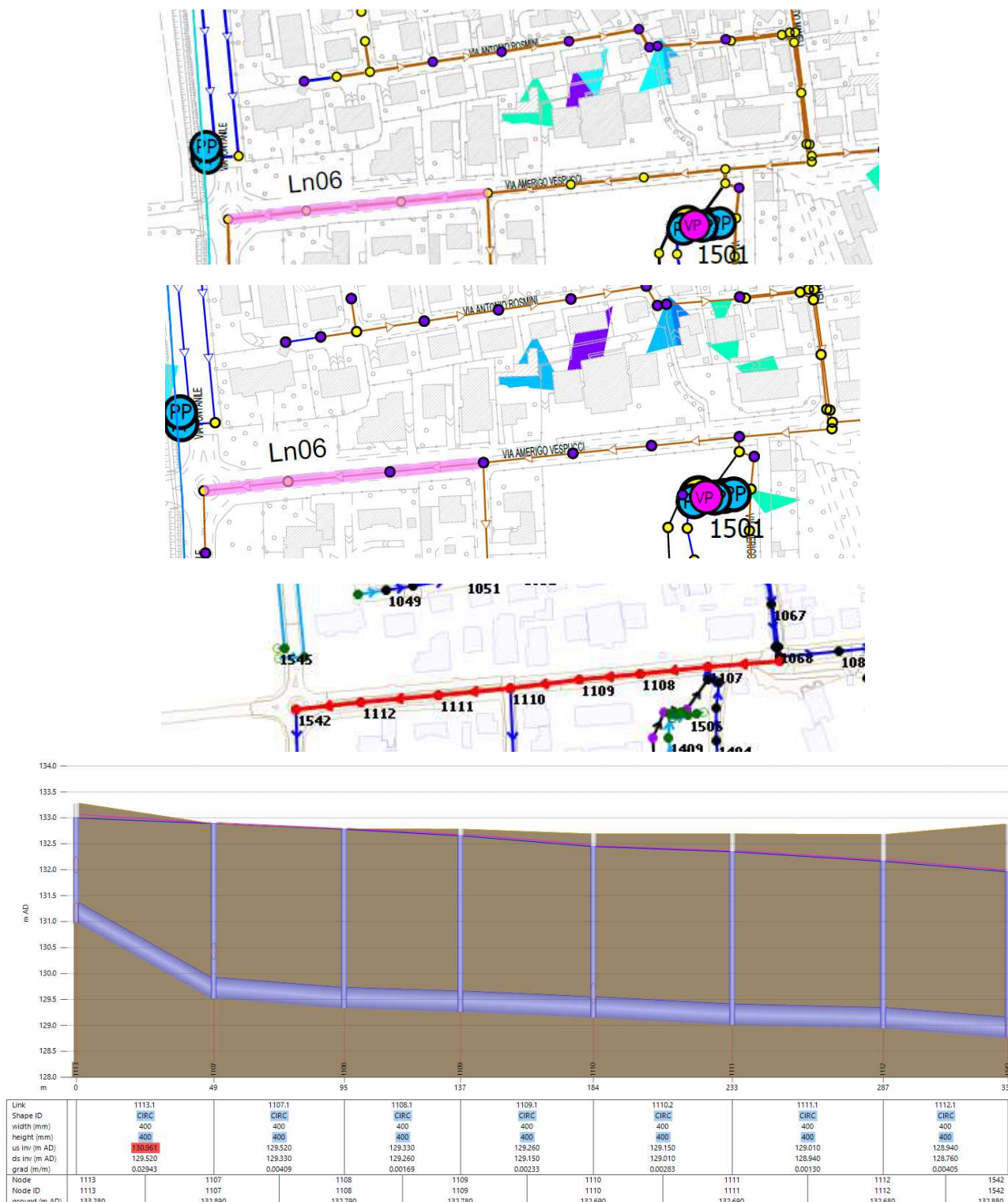
Figura 46 – Criticità via Vespucci angolo via Fontanile (pericolosità T=10 anni, pericolosità T=100 anni, profilo longitudinale con livelli idrici T=10 anni)
