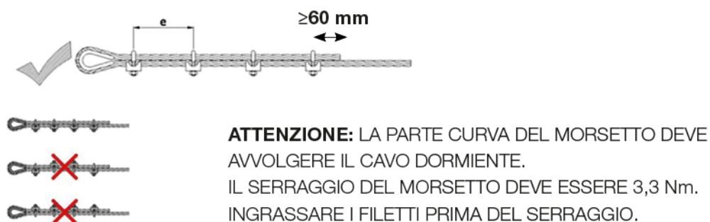
**Figura 5.8 - Posizionamento cavo con morsetti**
