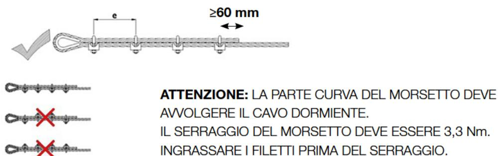
**Figura 5.6 - Posizionamento cavo con morsetti**
