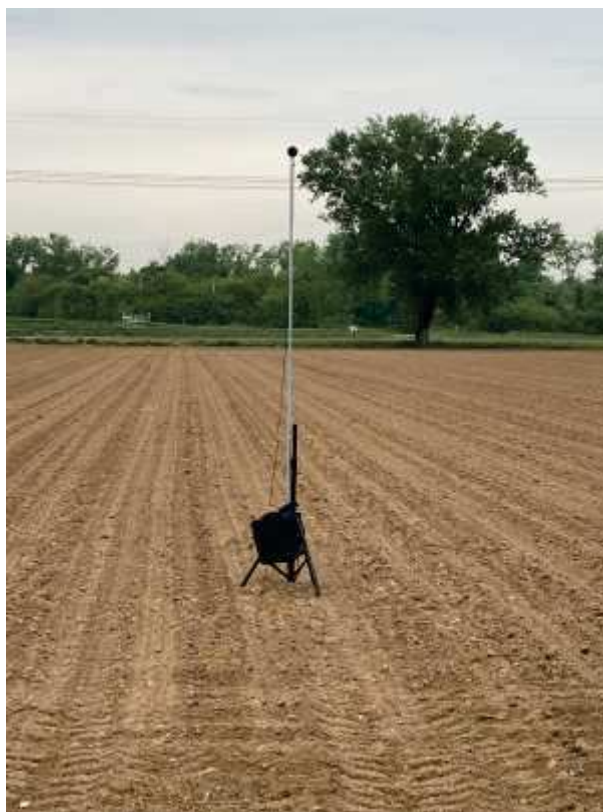
Foto 2: Fonometro in R1, ad altezza 4 metri
